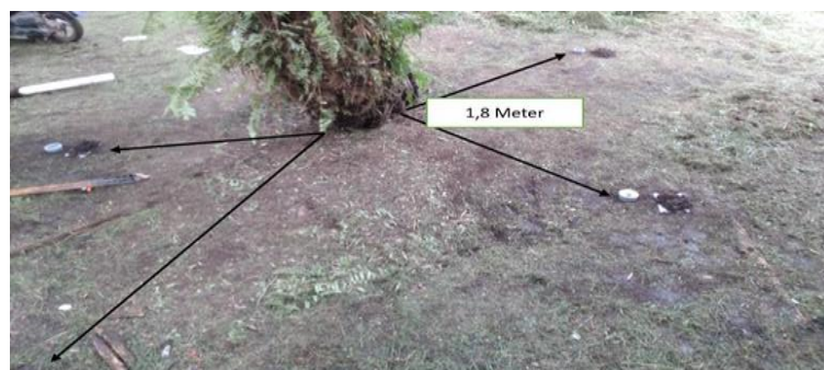
Gambar 3. Penempatan wadah di lapangan dengan tinggi air tanah 40 cm dan 60 cm
