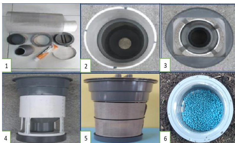
Gambar 1. Proses pembuatan wadah saringan pupuk lepas terkendali (1. Alat dan bahan, 2. Kerangka wadah dari atas, 3. Kerangka wadah dari bawah, 4. Kerangka wadah, 5. WSPLT, 6. WSPLT yang di isi pupuk NPK).
