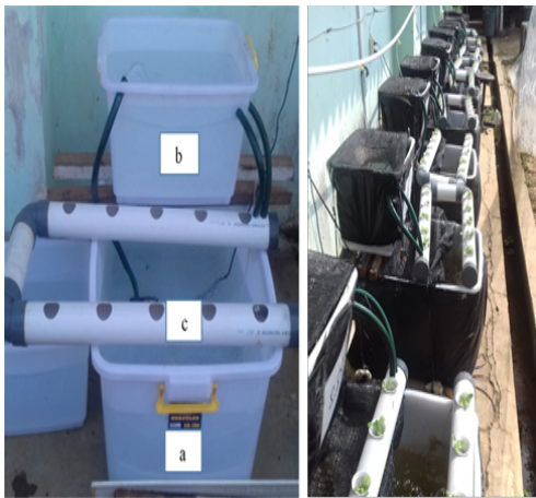
Gambar 1 Instalasi dalam penelitian. Keterangan: wadah pemeliharaan ikan (a), wadah pemeliharaan kijing (b), talang media pemeliharaan pakcoy (c).
