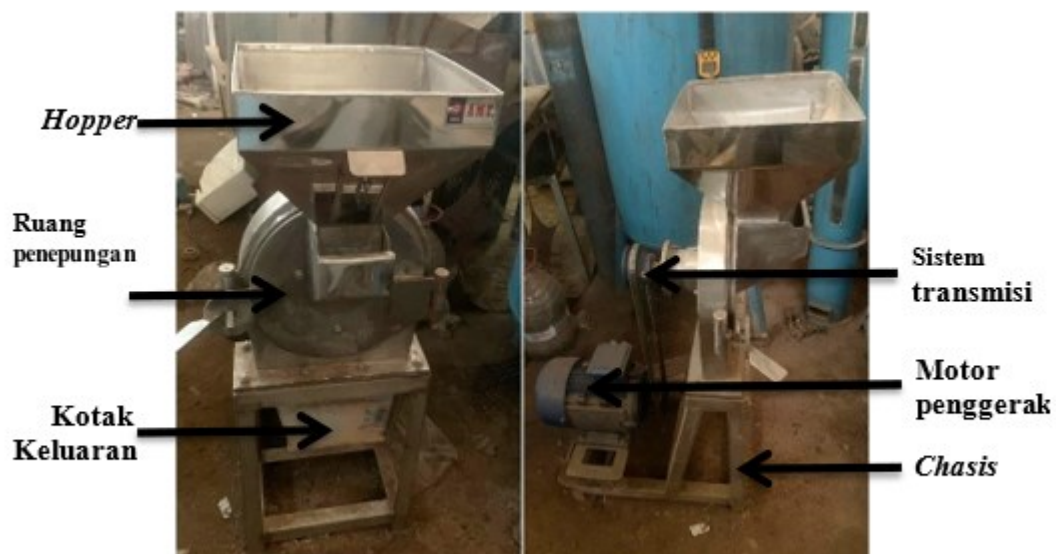
Gambar 1. Konstruksi mesin penepung tipe disc mill
