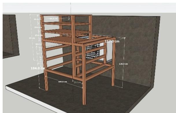
Gambar 3. Rak pengering aliran panas vertikal
