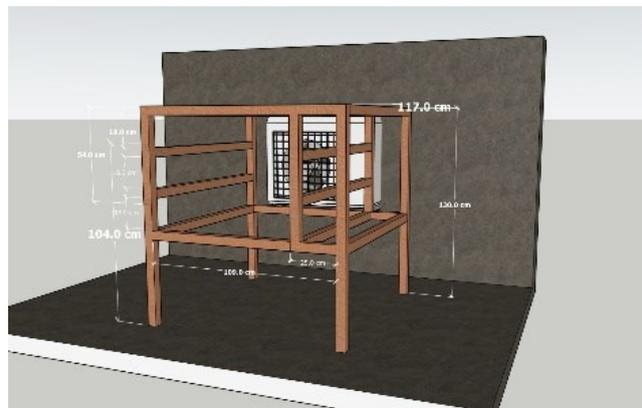
Gambar 2. Rak pengering aliran panas horizontal
