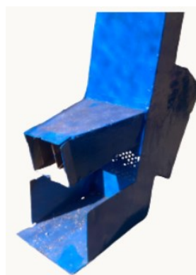
Gambar 12. Modifikasi rancangan manufaktur saluran pemisah bagian kulit polong
