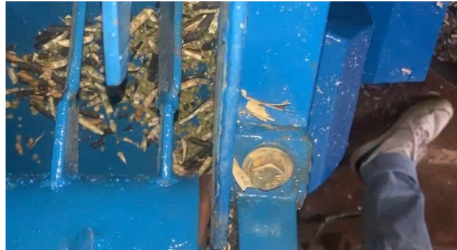
Gambar 10. Keadaan mulut saluran yang terhambat
