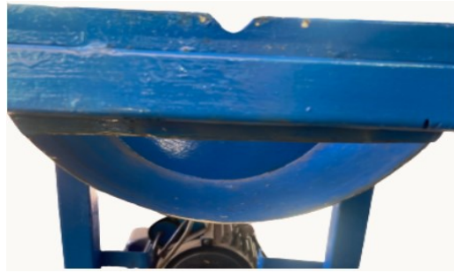
Gambar 13. Modifikasi rancangan manufaktur saluran keluar utama dari hasil penghancuran kacang hijau beserta polongnya
