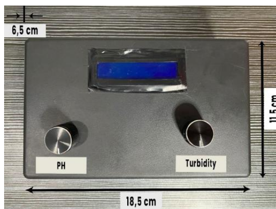
Gambar 2. Prototipe alat portabel estimasi kadar ALB pada CPO berbasis Arduino
