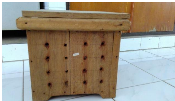
Gambar 1. Kotak fermentasi kakao kapasitas 5 kg
