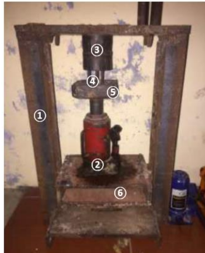
Gambar 2. Pencetakan pelet menggunakan dongkrak: ① Rangka, ② Dongkrak, ③ Cetakan ( die ), ④ Batang penekan, ⑤ Bantalan batang penekan, ⑥ Landasan.
