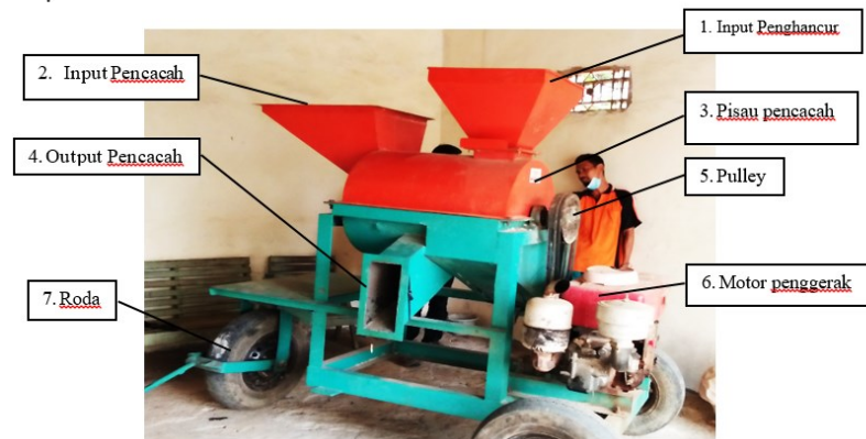
Gambar 1. Mesin pencacah ( Chooper ) di Desa Sumber Agung, Metro Kibang
