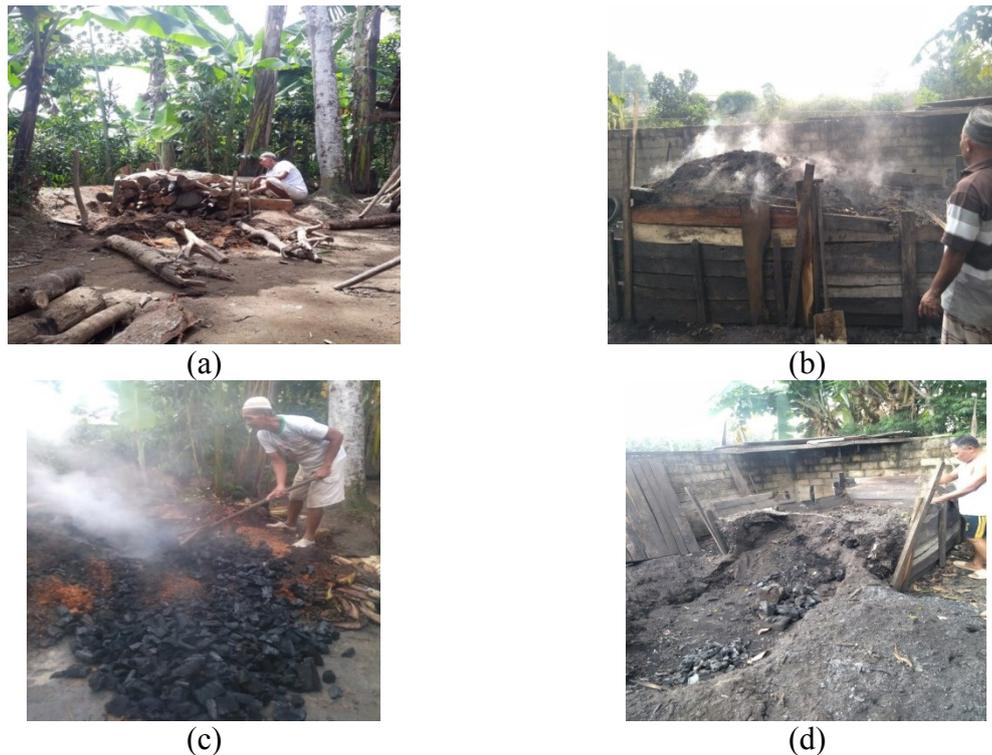
Gambar 2. Proses pembuatan arang (a) penyusunan kayu, (b) pembakaran hari ke-3, (c) pemanenan (metode siram), dan (d) pemanenan (tanpa siram)
