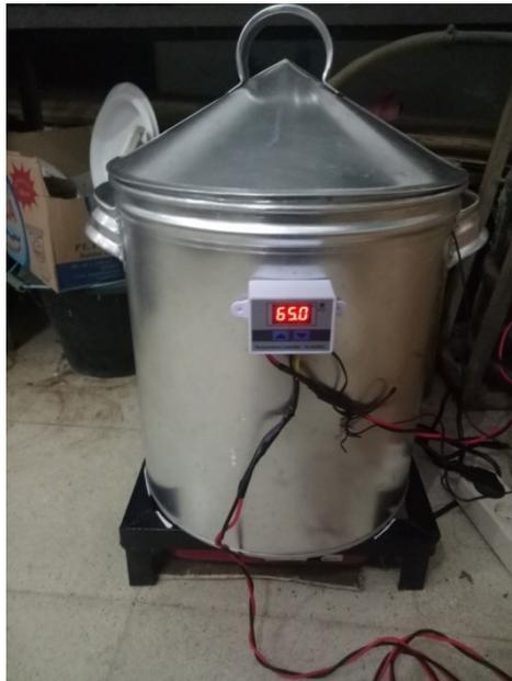
Gambar 2. Alat pengasin telur berdasarkan prinsip termos
