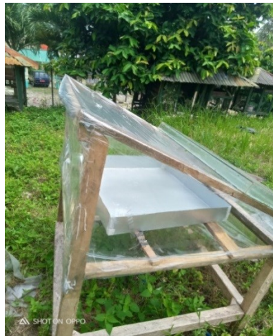
Gambar 8. Alat kondensasi model rumah kaca
