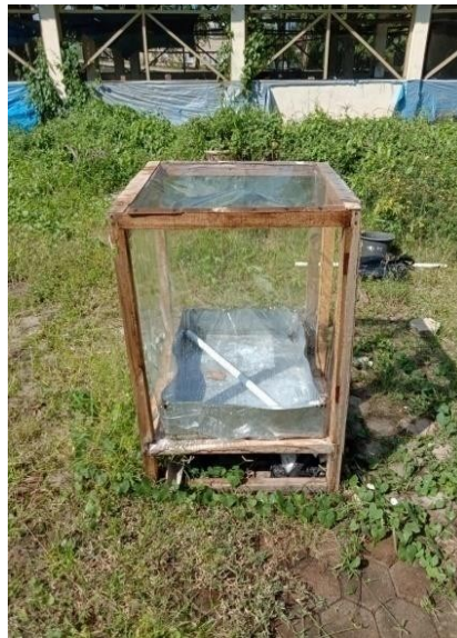
Gambar 7. Alat kondensasi uap air laut penelitian sebelumnya
