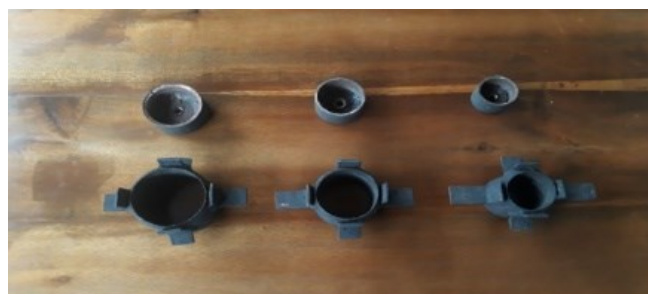
Gambar 4. Besi pemotong dan pencetak buah jengkol
