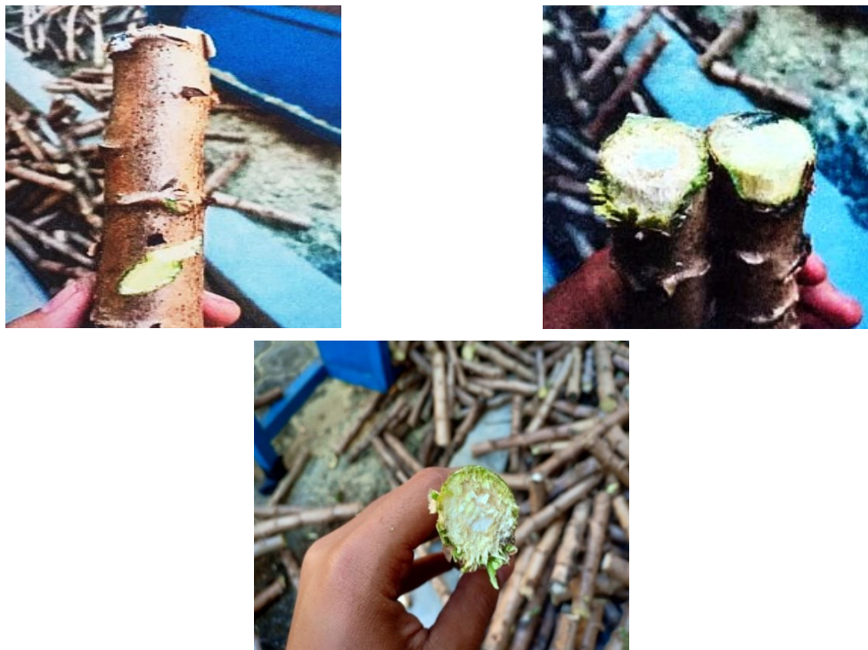
Gambar 4. Kerusakan hasil potongan
