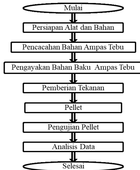
Gambar 2. Diagram alir penelitian pembuatan pelet dari bagas tebu
