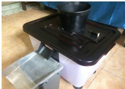
Gambar 2. Alat pemisah *kernel* dengan cangkang kelapa sawit
