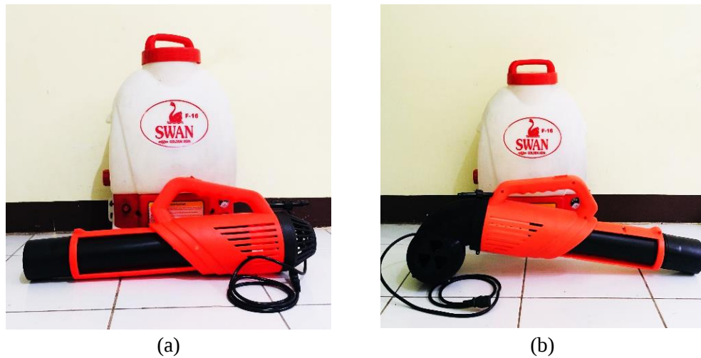
Gambar 2. Sprayer elektrik dan air blower yang digunakan: (a) air blower original (dengan kipas aksial) dan (b) air blower modifikasi (dengan kipas sentrifugal)
