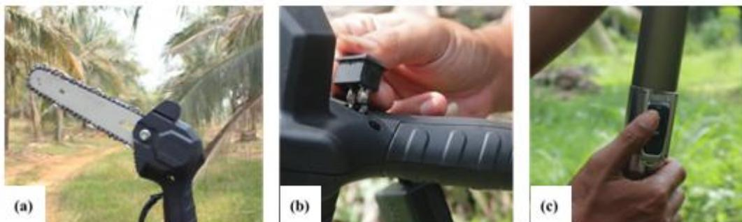
Gambar 8. Komponen bagian gergaji elektrik: (a) mata gergaji, (b) Switch, (c) remote control
