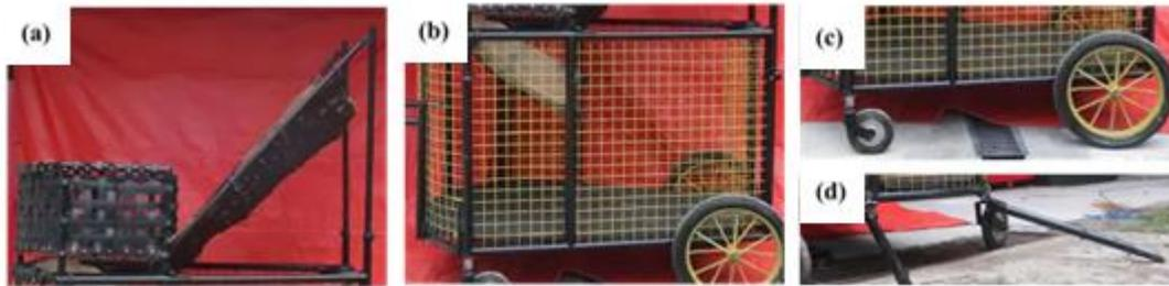
Gambar 7. Komponen bagian Portable Trolley: (a) peredam, (b) penampung, (c) roda Pneumatik, (d) kaki pijakan
