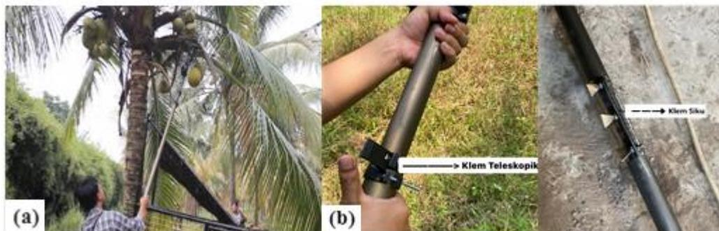
Gambar 6. Komponen bagian *Telescopic Sticks* (a) *Telescopic Sticks*, (b) Klem teleskopik dan klem siku
