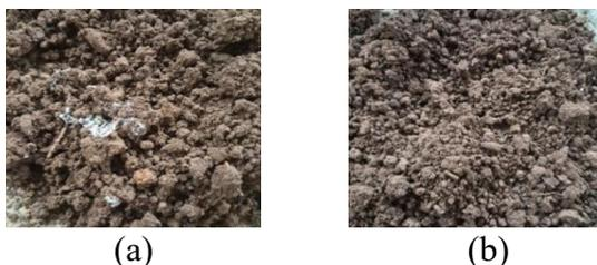
Gambar 7. Pengujian biodegradabilitas bioplastik (a) Minggu ke-1, (b) Minggu ke-2
