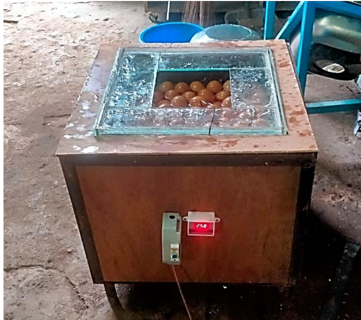
Gambar 4. Pengujian alat pembuatan telur asin
