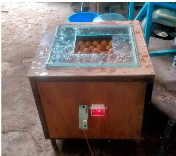
Gambar 2. Alat pembuat telur asin hasil modifikasi
