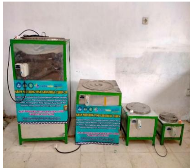
Gambar 1. Alat pembuat telur asin yang telah dikembangkan dengan 4 kapasitas
