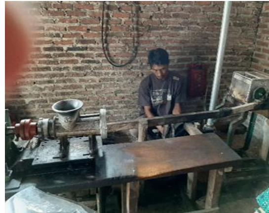
Gambar 2. Alat pamarut singkong dan penggiling adonan kelanting
