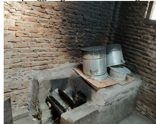
Gambar 4. Tungku Pengukus singkong parut
