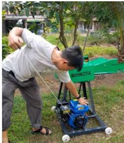
Gambar 5. Proses menghidupkan motor bensin
