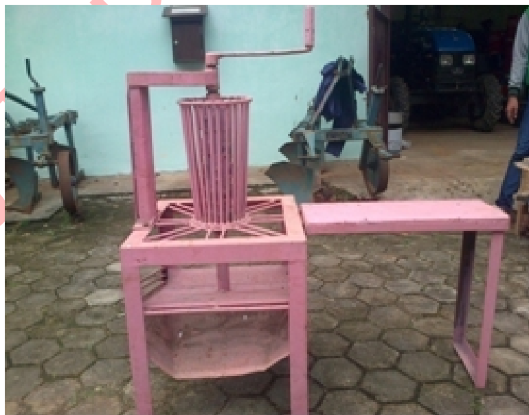
Gambar 4. Alat pemipil jagung semi mekanis hasil modifikasi
